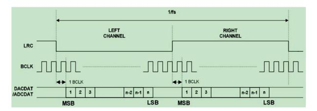
在 DSP/PCM 模式, 左通道的 MSB 在尾随 LRC 的一个上升沿的 BCLK 的第一个(mode B) 或者第二个(mode A) 上升沿传输, 右通道数据紧跟着左通道数据。传输依赖于字长、BCLK 频率和采样率, 在右通道数据的 LSB 和下一个采样之间应该有不使用的 BCLK 周期。
