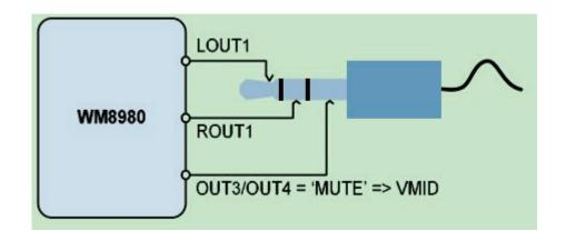
当使用直流耦合电容时,他们的电容和负载电阻一起确定低频截止频率 fc。电容增加就会减少 fc,提高低音响应;反之减少电容值就会减少低音响应。假设负载是 16 Ω,耦合电容是 220uF:
