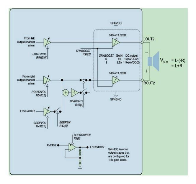
LOUT2/ROUT2 的输出信号是由左/右混合器电路提供,DAC 输出,旁路线路(输入推动的输出)和 AUX 输入等信号以任何方式混合。LOUT2/ROUT2 音量可以通过寄存器 LOUT2VOL/ROUT2VOL 进行控制。注意当信号过大增益超过 0dB 会导致信号被截断。LOUT2MUTE/ROUT2MUTE 寄存器可以使扬声器输出无声。因为输出引脚保持同样的直流电平,所以消声或者有声都不会产生"咔哒"噪声。
