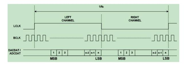
在 I2S 模式,在跟随 LRC 传输的 BCLK 的第二个上升沿时传输 MSB,其他位一直到 LSB 按顺序传输。传输依赖于字长、BCLK 频率和采样率,在每个采样的 LSB和下一个采样的 MSB 之间都应该有未用的 BCLK 周期。
