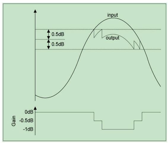
限幅器有接近 0dB 的可调的上限增益,正常操作时信号低于这个极限所以不受限幅器影响。如果信号超过这个极限就会被以一个特定衰减率进行削弱直到信号低于上限。这个限幅器还有一个低于上限 1dB 的下限,当信号低于这个下限时信号就会以一个特定的放大率放大直到增益达到 0dB。这两个限制都是由寄存器LIMLVL 控制,上限比 LIMLVL 的可调值大 0.5dB 而下限比这个值小 0.5dB.
