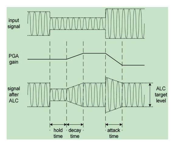
ALC/限幅功能通过设置寄存器 ALCSEL 进行使能。当它使能时录音的音量可以通过 ALCLVL 寄存器调节在-6dB 到-28.5dB 范围(与 ADC 的满度成比例)。PGA 的上限增益可以通过寄存器 ALCMAX 进行设定,PGA 的下限增益可以通过寄存器 ALCMIN 进行设定。
