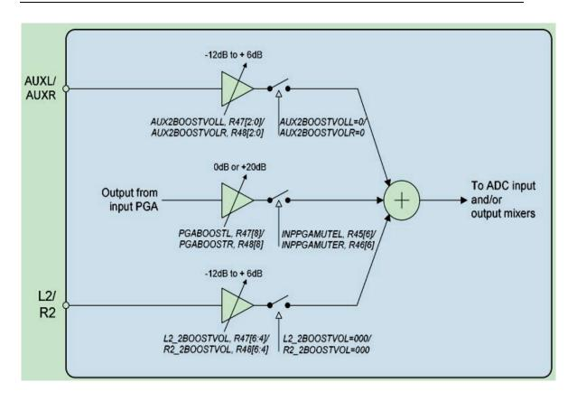
输入 PGA 有+20dB 的推动 (PGABOOSTL/R=1), 0dB 通过 (PGABOOSTL/R=0) 或者完全和输入推动电路隔离 (INPPGAMUTEL/R=1)。
