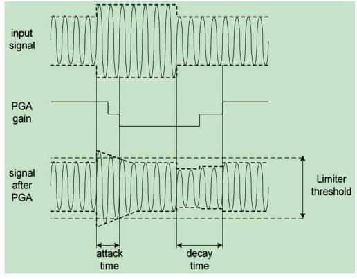
在 ALC 模式 (ALCMODE 位=0), 电路旨在保持一个不变的录音声音无论输入信号的电平如何。通过不断的调整 PGA 的增益可以达到这个要求, 所以 ADC 输入的信号电平保持不变。一个数字峰值探测器探测 ADC 的输出从而改变 PGA 的增益。
