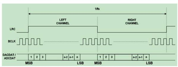
在右对齐模式,在跟随 LRC 传输的 BCLK 的最后一个上升沿时传输 LSB,其他位在前面传输。传输依赖于字长、BCLK 频率和采样率,每个 LRC 传输后都应该有未用的 BCLK 周期。
