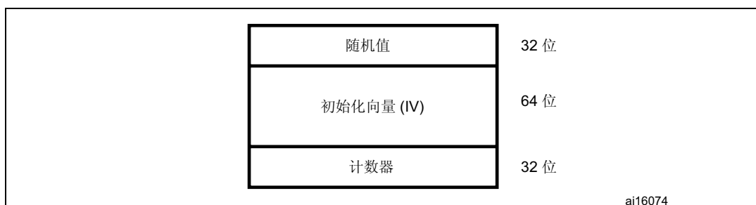
图 213. 计数器模式下的初始计数器块结构
